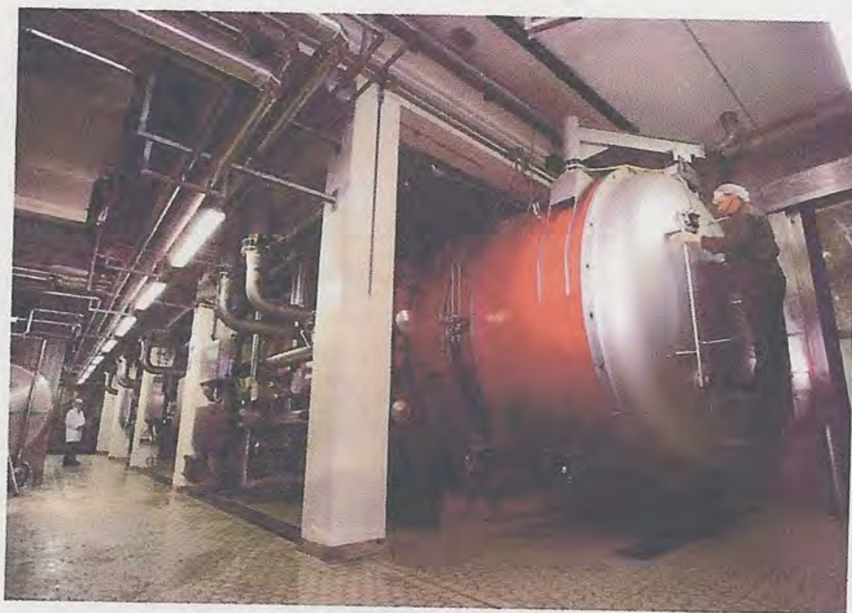
La lyophilisation permet d'obtenir en trois étapes des produits de bonne qualité. La matière première est tout d'abord surgelée (de -20 °C à -80 °C). La deuxième étape est la dessiccation primaire sous-vide, où l'eau libre est sublimée. La dessiccation secondaire permet d'extraire par désorption l'eau liée.
